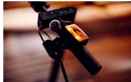
3. Fixe o suporte do comando remoto num dos punhos do guiador do seu veículo. Depois, prenda o segundo controlo remoto no devido suporte.
